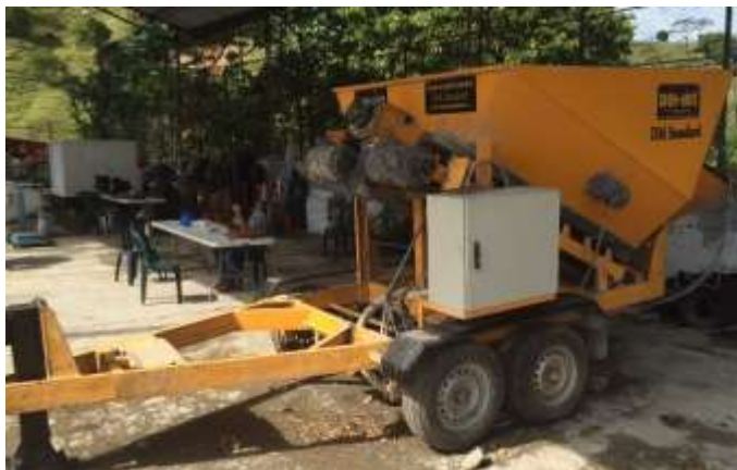
Fotografía 8.2 Planta de concreto, proyecto Cantayús.
